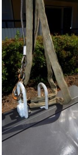
Två-krokssystemet för kranbilen att angöra vid tömning.
