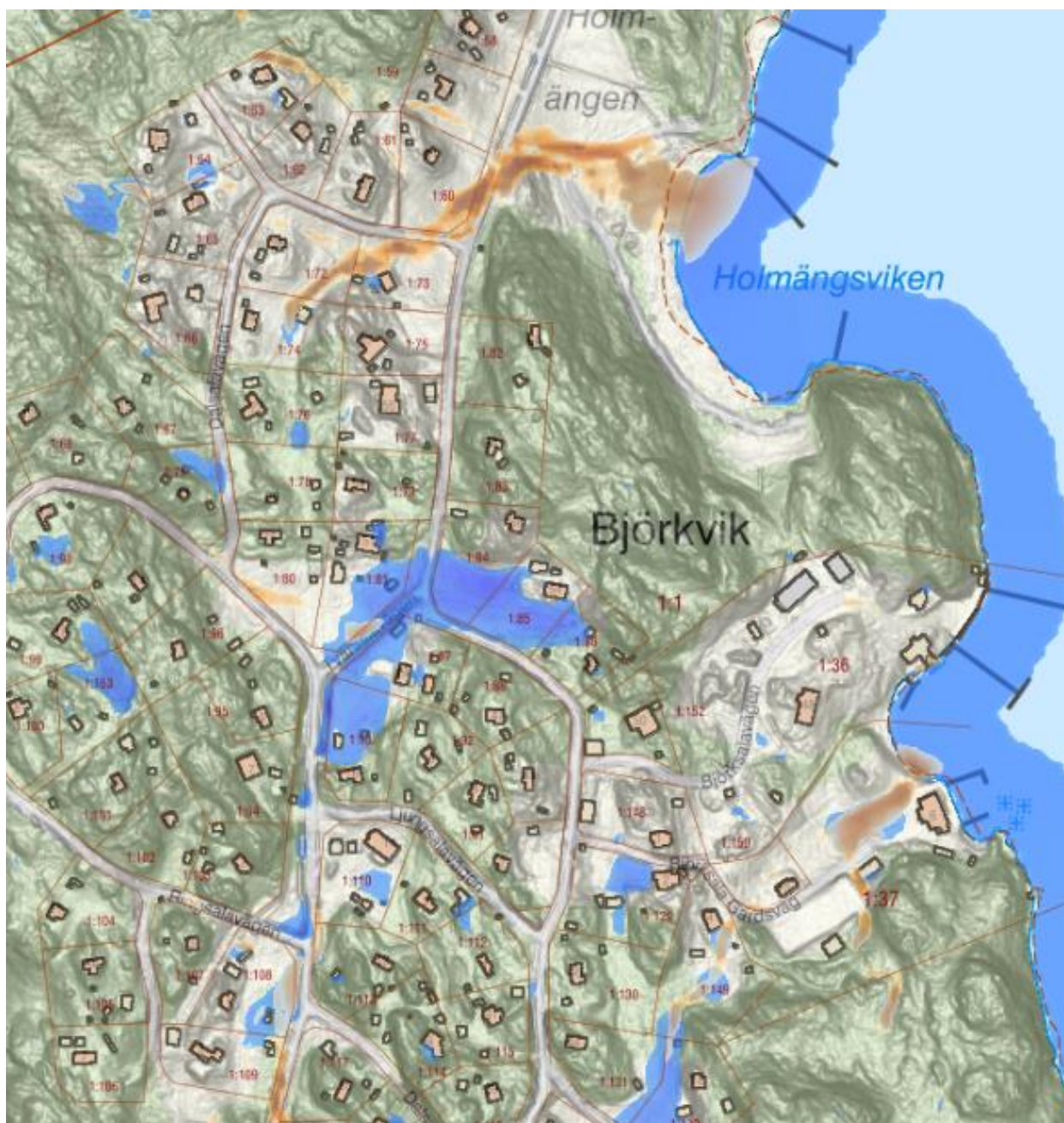
Figur 23. Utsnitt över översvämning och flödesvägar i den norra delen av planområdet. Vattendjup under 20 cm visas ej.
